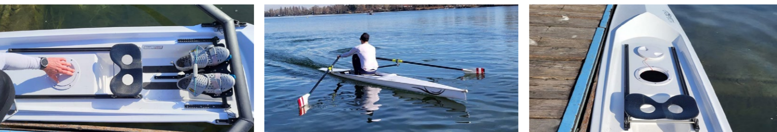
Das neue Lite Boat: Modell „River S“, französisches Fabrikat, Länge: 5 m, Breite 0,75m, Bootsgewicht: 26 kg
